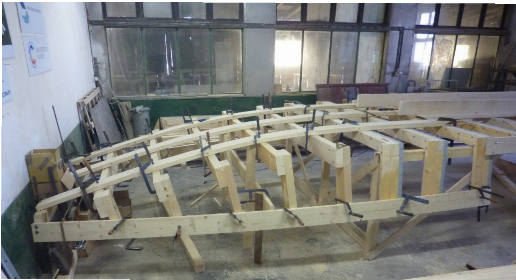
Montáž kostry přední části šífu – poslední fotodokumentace ze stavby 4. července 2018
