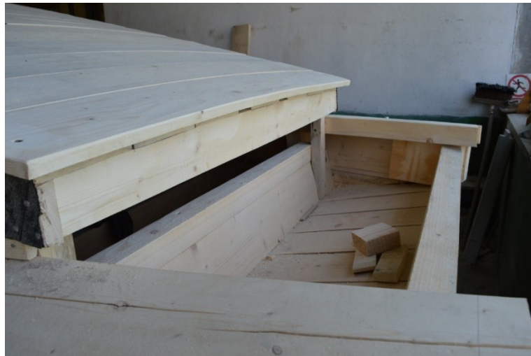
Zadní část šífu před uložením čepu kormidla
